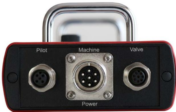
Abbildung 8: Steckeransicht des Prüfgerätes ValveExpert Checker 2.3. Siehe Tabellen 3 und 4 für die Anschlussbelegung.
